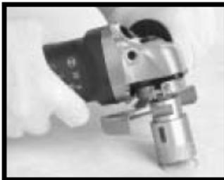
Bohrkronen leicht schräg am zu bohrenden Punkt ansetzen und **mit Winkelschleifer langsam kreisende Bewegungen ausführen**. Auf diese Weise wird Überhitzung vermieden. **Kühlpausen einhalten**.
